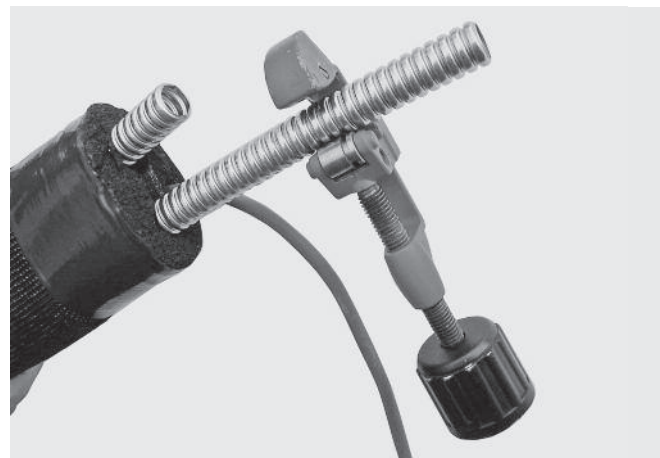
Fig. 3 Découpe avec le coupe-tubes
