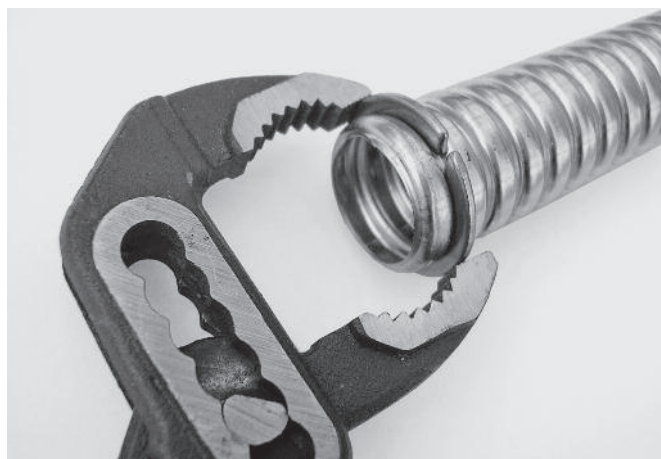
Fig. 4 Inserimento rondella di serraggio
