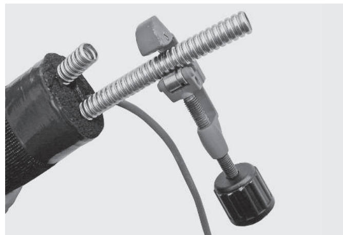
Fig. 3 Cortar a medida con el cortatubos
