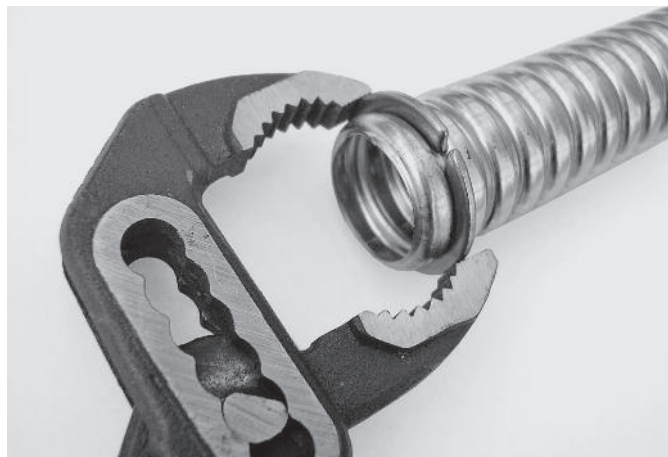
Fig. 4 Colocación de la arandela de apriete
