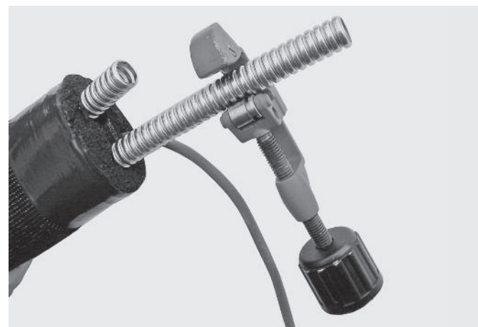
Abb. 3 Ablängen mit Rohrabschneider
